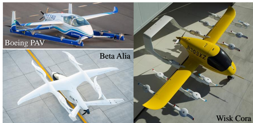
Fig. 1: “Lift plus cruise” eVTOL configurations
